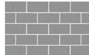
„zidarsko“ slaganje moguće kod svih tipova klinker opeke
